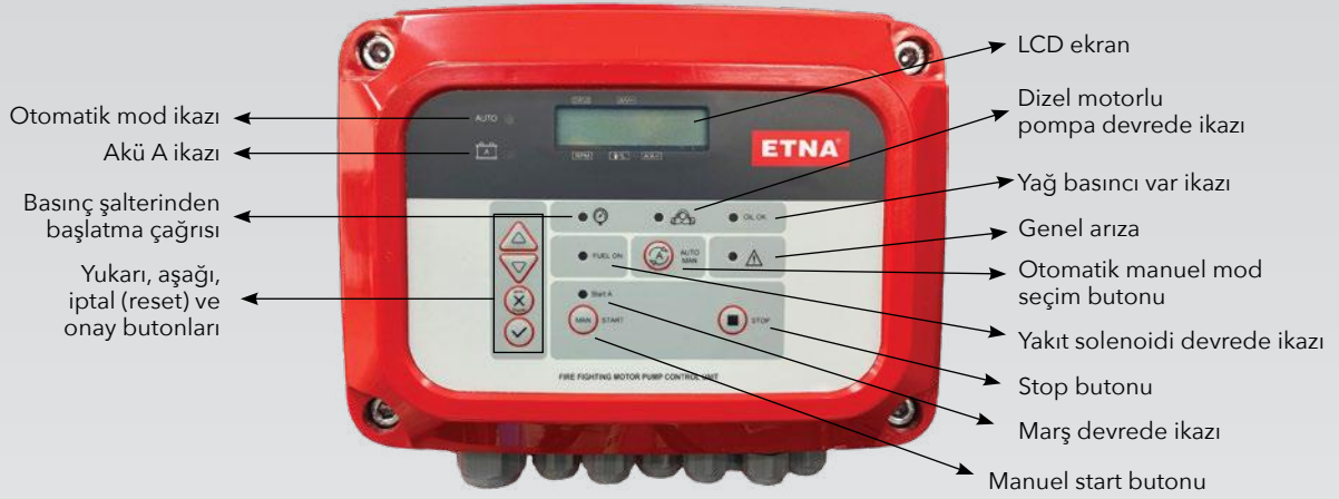
Şekil 3: Kontrol paneli açıklamaları
