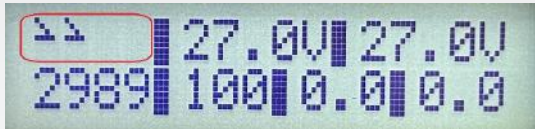
Şekil 8. Dizel motor çalışıyor, basma kollektöründe basınç yok (60 numaralı basınç kontrol klemensine basınç kontrol sensöründen gnd sinyali gelmiyor), rölanti süreci bitti (dizel yüksek hızda çalışıyor)
