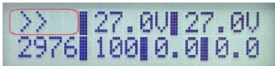
Şekil 10. Dizel motor çalışıyor, basma kollektöründe basınç var (60 numaralı basınç kontrol klemensine basınç kontrol sensöründen gnd sinyali geliyor), rölanti süreci bitti (dizel yüksek hızda çalışıyor)
