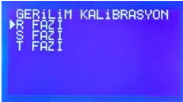
Şekil 15. Gerilim Kalibrasyon Ekranı
