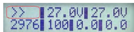
Şekil 10. Dize motor çalışıyor, basma kollektöründe basınç var (60 numaralı basınç kontrol klemensine basınç kontrol sensöründen gnd sinyali geliyor), rölanti süreci bitti (dize yüksek hızda çalışıyor)
